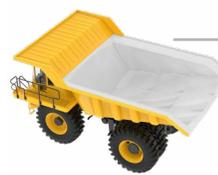
Cubierta de UHMW-PE en tolva de material para evitar apelmazamiento de material
